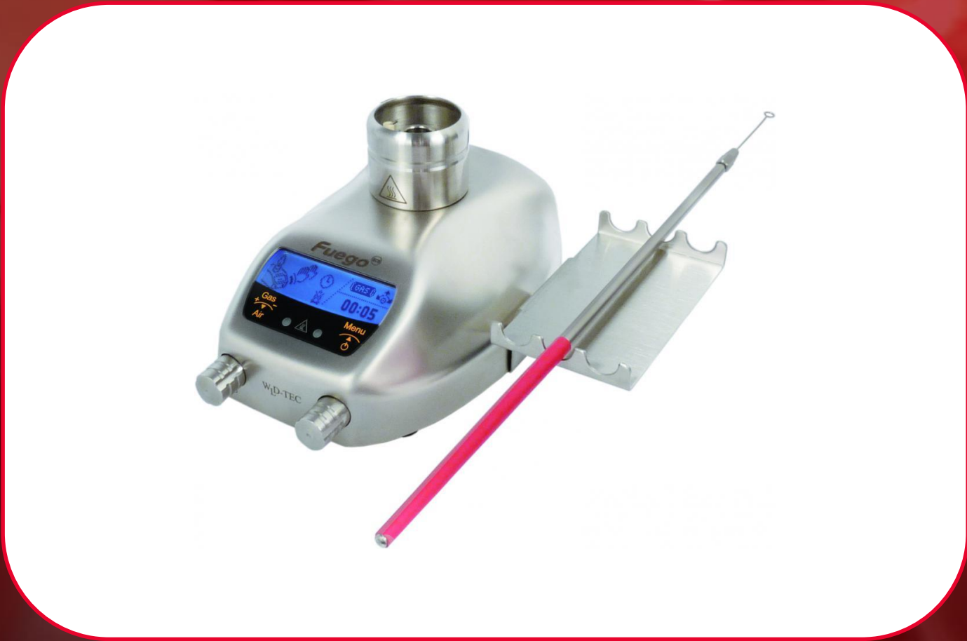
Stojan na mikrobiologické očká - sterilizátor
